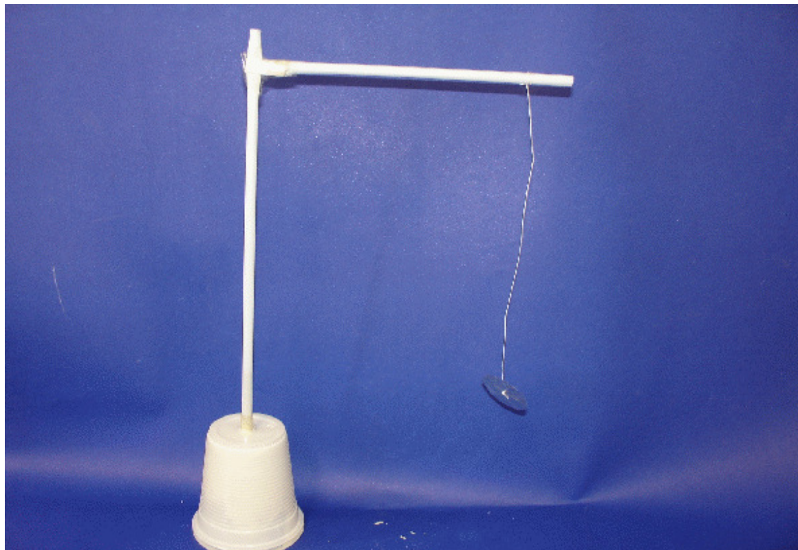
Figura 10: Pêndulo Eletrostático totalmente concluído.
