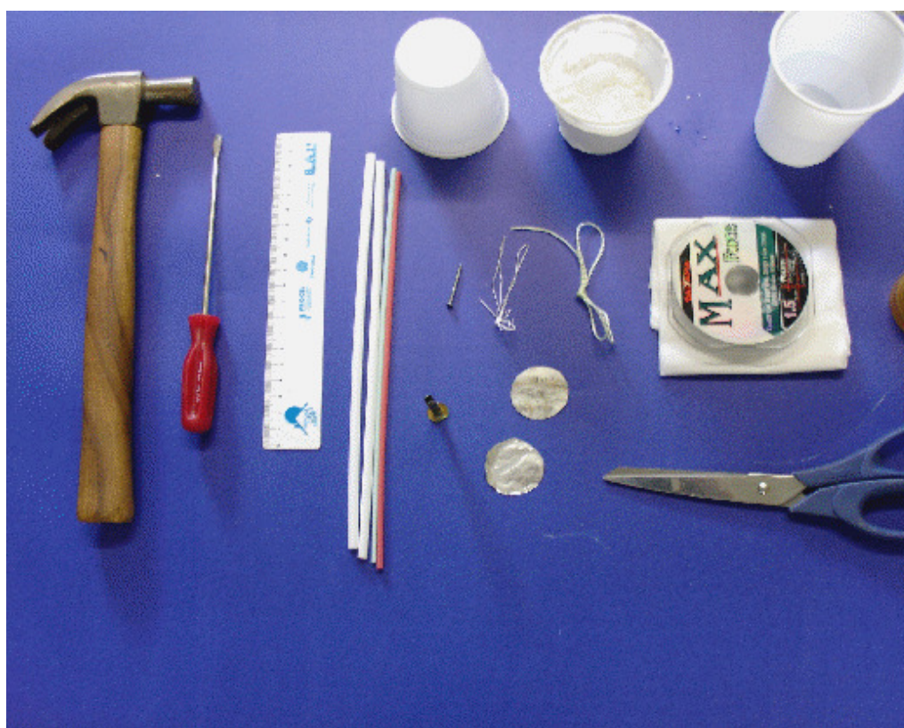
Figura 1: Material utilizado na experiência do Detector de Cargas; Começando da esquerda para a direita, tem o martelo, a chave de fenda, a régua, os canudos de plástico, dois copos plásticos (pequeno, médio ou grande), prego, um colchete, gesso em pó, linha de algodão,
