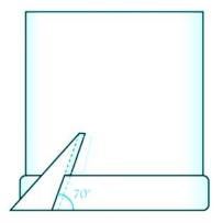
tor que ele passa a girar (veja a figura). Aletas distribuídas regularmente em torno da aba e inclinadas em relação ao eixo do rotor permitem que ele gire automaticamente tão logo seja arremessado. Siga as instruções abaixo para obtê-las e fixá-las no corpo do rotor.
