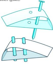
3) Com o arame faça uma estrutura de suporte para a asa que a permita deslizar facilmente na vertical.
