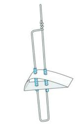
4) Posicione o secador de cabelos como indicado e ligue-o (ar frio). Incline a asa aos poucos e observe o que acontece quando o ângulo de inclinação ("ângulo de ataque") aumenta.
